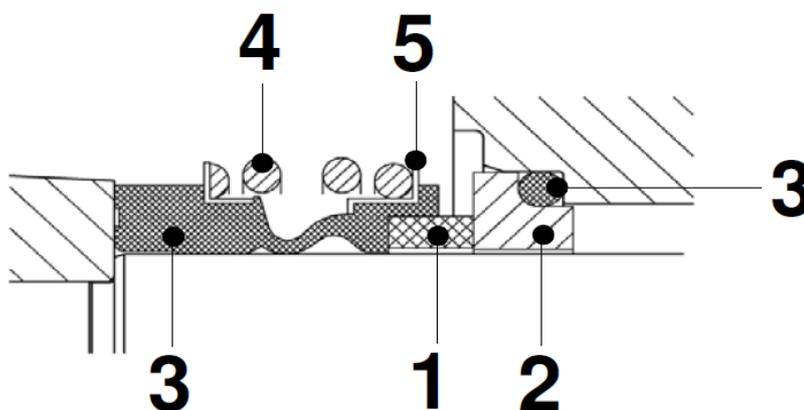
Рисунок 4. Схема торцевого уплотнения
