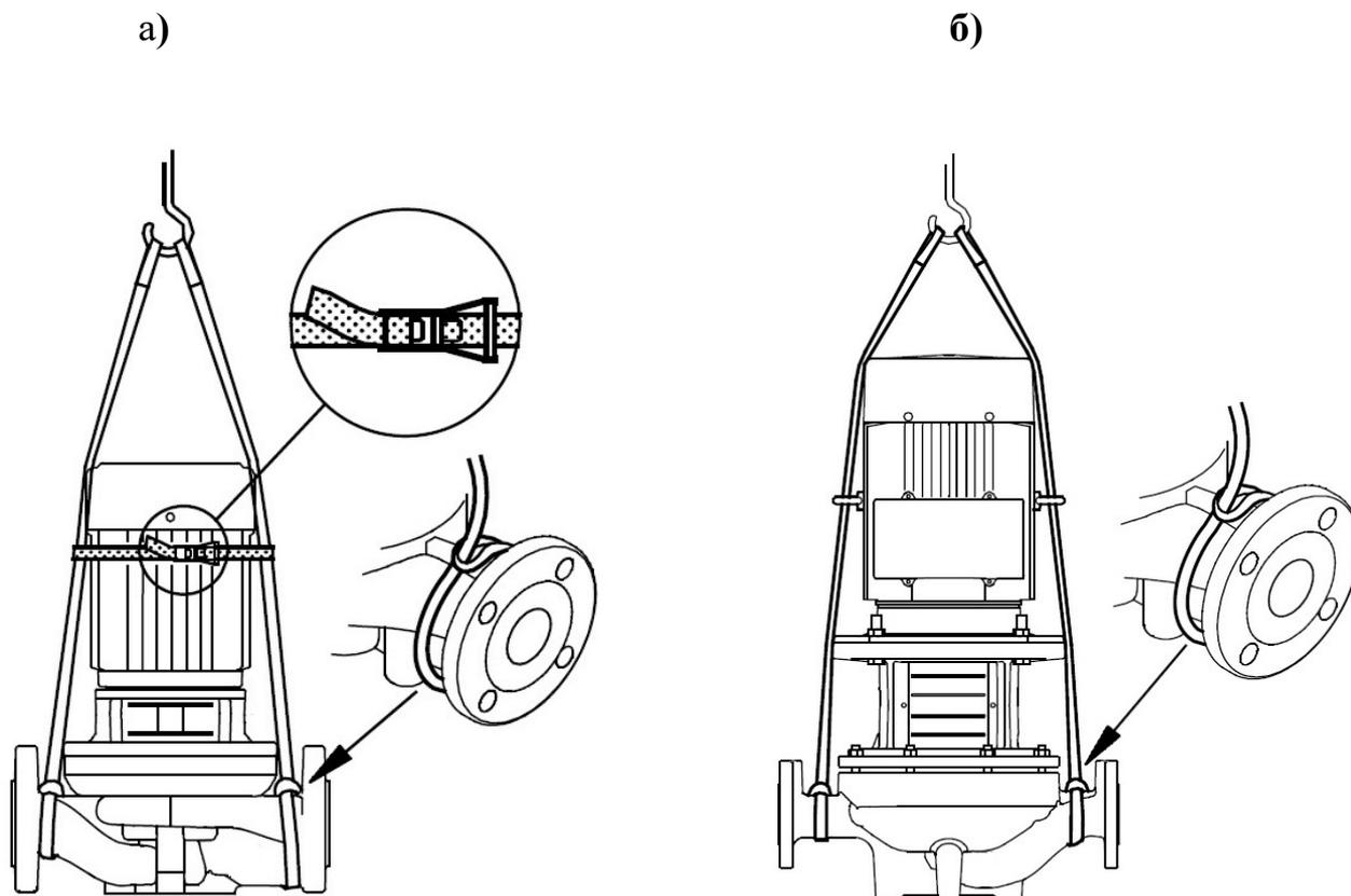
Рисунок 5. Схема строповки
