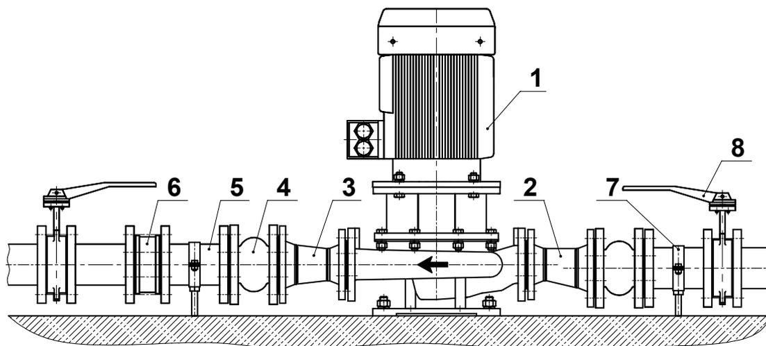
Рисунок 1. Монтаж агрегата: 1 – агрегат, 2 – переход эксцентрический, 3 – переход концентрический, 4 – компенсатор резиновый, 5 – патрубок, 6 – клапан обратный, 7 – опора, 8 – запорное устройство.
