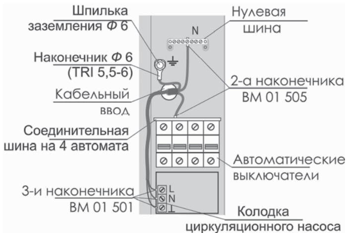
Рис.4 Подключение РусНИТ - 206К, 207К, 208К, 209К к однофазной сети
