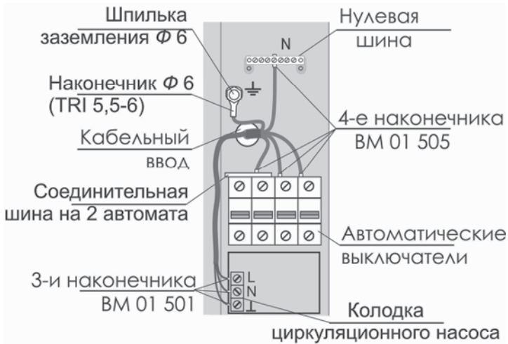
Рис.5 Подключение РусНИТ - 206К, 207К, 208К, 209К к трёхфазной сети
