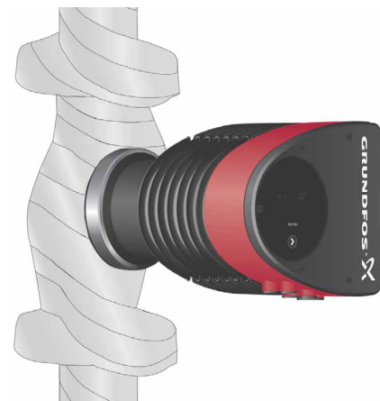
Рис. 17 Изоляция корпуса насоса и трубопровода
