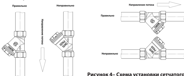
Рисунок 4– Схема установки сетчатого фильтра
