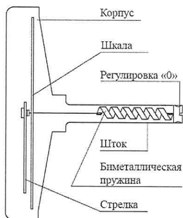
Рис.1 – Конструкция прибора
