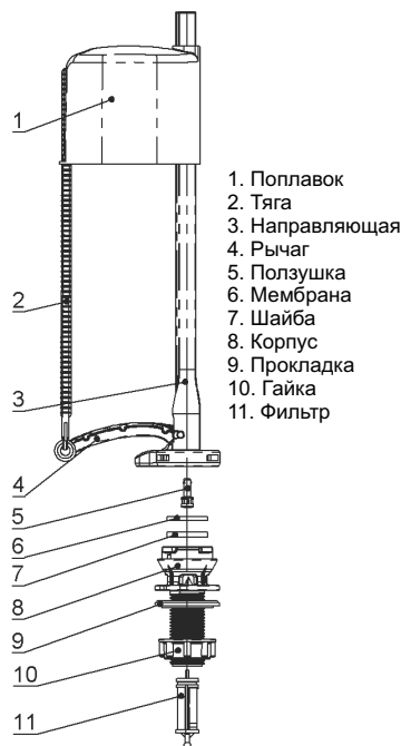
Рис. 1 - Клапан впуска (нижняя подводка)
