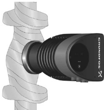
Рис. 17 Изоляция корпуса насоса и трубопровода
