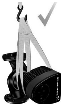
Рис. 7 Правильный способ строповки насоса
