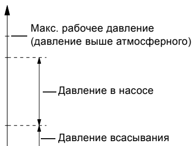
Рис. 5 Давление в насосе
