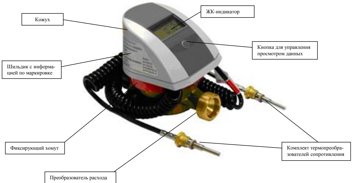
Рисунок 2. Внешний вид и состав теплосчётчика ELF-M
