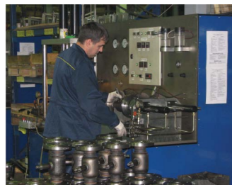
Тестирование шаровых кранов
