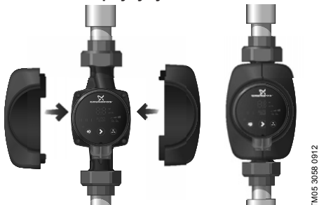
8-сүр. Соркысманын корпусунун изоляцисы
