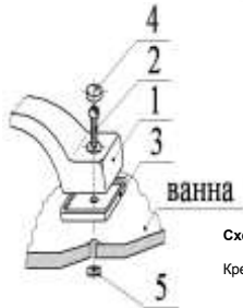
Схема 2. Крепление уравнивателя электрических потенциалов
