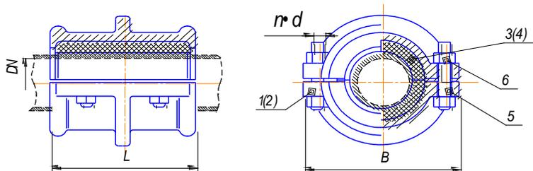
1.2. Муфта состоит из полумуфт (1, 2), вкладышей (3, 4), шпилек(5), гаек (6).
