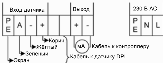
Рис. 5 Электросхема для подключения усилителя
