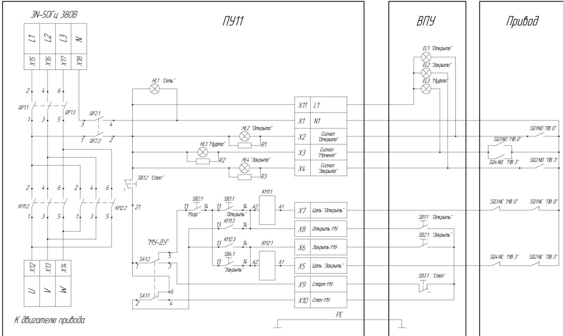
Состояние контактов SA1.1 и SA1.2 – в положении "ДУ"
