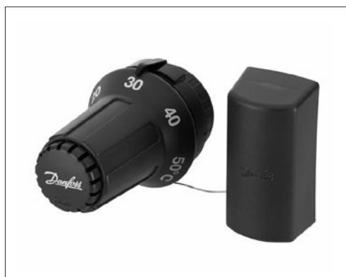
Терmostатический элемент FTC применяют для регулирования температуры теплоносителя в системах напольного или радиаторного отопления. Терmostатический элемент FTC в сочетании с двухходовым клапаном RA-N представляет собой регулятор температуры прямого действия.
