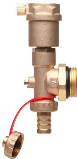
Воздухоотводчик тип FHF входит в концевую секцию вместе со сливным краном и используется совместно с коллеткорами FHF. Концевая секция служит для удаления лишнего воздуха из системы, а также дренажа через сливной кран. Продукция не предназначена для контакта с питьевой водой.
