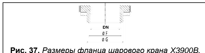
Рис. 37. Размеры фланца шарового крана Х3900В.
