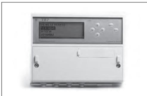
Тепловычислитель предназначен для вычисления и учета тепловой энергии и количества теплоносителя в закрытых и открытых водяных системах теплоснабжения. Тепловычислитель ТВ7-04 предназначен для работы в составе теплосчетчиков, обслуживающих два теплообменных контура (тепловых ввода ТВ1 и ТВ2), представленных трубопроводами: подающий (тр1), обратный (тр2), ГВС, подпитки или ХВС (тр3). В каждом тепловом вводе могут быть установлены 3 датчика объема, 3 датчика температуры и 2 датчика давления.
