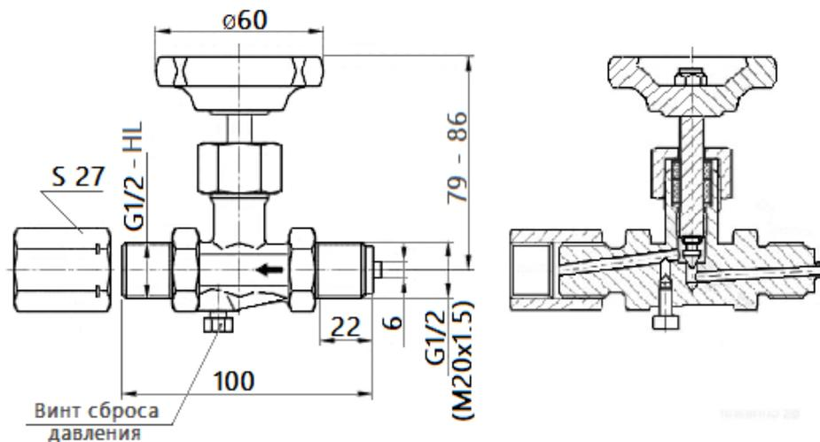
Принцип работы игольчатого вентиля прост: при вращении рукоятки по часовой стрелке приводится в движение шток со шпинделем, шпиндель при этом ввинчивается в резьбу корпуса и перекрывает просвет. При вращении в обратном направлении шток поднимается и просвет освобождается.
