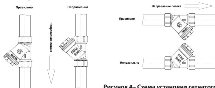
**Рисунок 4– Схема установки сетчатого фильтра**
