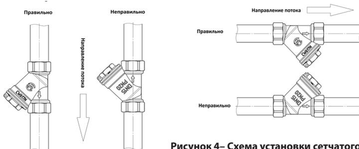
**Рисунок 4– Схема установки сетчатого фильтра**
