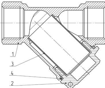
Рисунок 2 – Конструкция фильтра
