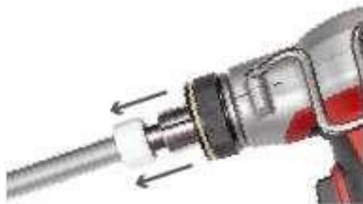
4. Включить расширитель. После каждого цикла расширения без усилий надвигать трубу на головку расширителя. Каждый цикл расширения сопровождается отчетливо слышимым щелчком расширительной головки. После полного продвижения трубы на головку необходимо провести несколько циклов расширения. В стандартных условиях:
